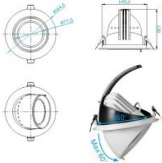
Deckenausschnitt:  $\varnothing$  183mm
