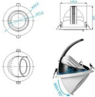
Deckenausschnitt:  $\varnothing$  183mm
