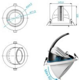
Deckenausschnitt:  $\varnothing$  183mm
